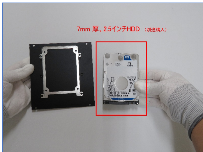
7. HDD 厚さ7mm 2.5 インチの取付け
